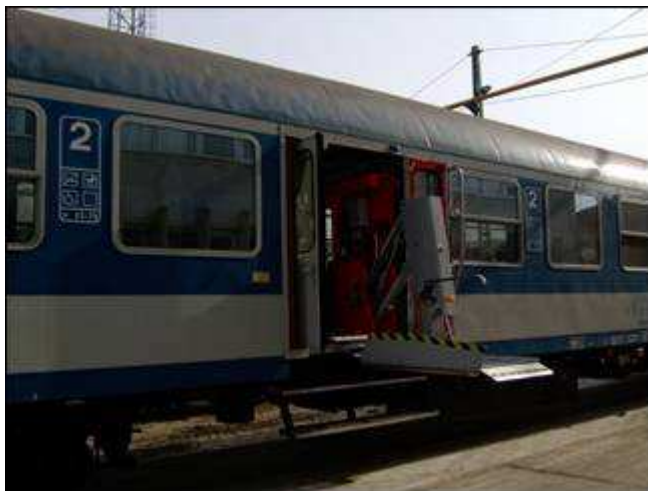
Kerekesszék emelő a 80-55 sorozatú vezérlőkocsiban
